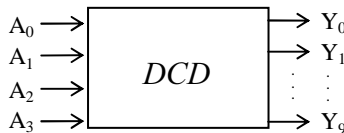
Fig. 4.38. Schema bloc a decodificatorului BCD - zecimal
