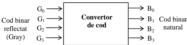
Fig. 4.30. Schema bloc a convertorului de cod "Gray - binar natural"
