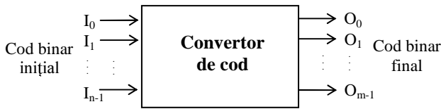
Fig. 4.26. Schema bloc generală a unui convertor de cod
